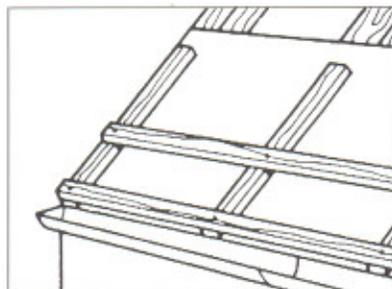
Si la pente du toit est supérieure à 30%, faire chevaucher les lés sur 12 cm - et au moins sur 20 cm, si la pente du toit est inférieure à 30% (le fil de marquage noir est parallèle au bord à une distance d'env. 12 cm).
